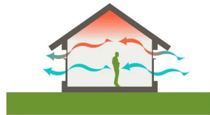
Gambar 10: Konsep ventilasi silang (Sumber : Hugh, 2022)
